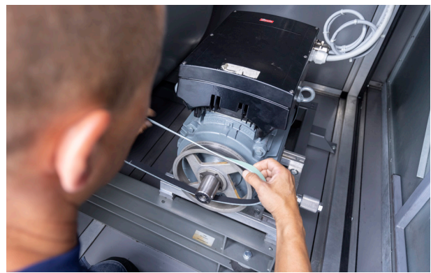
Motorpflege: Auch ohne Riemenwechsel wird dieser kurz entfernt, um das Lager des Motors zu überprüfen. Bei Lagerspiel oder rauhem Lauf tauschen wir das Lager und retten so den Motor.
